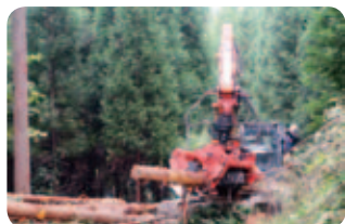
プロセッサによる造材作業実習
