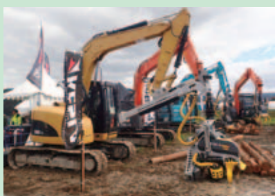
アームが伸縮できるプロセッサ 旋回時、アタッチメントの重心を機体に近づけ遠心力による転倒を防ぐ構造
