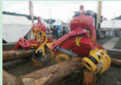
WOODY ハーベスタ 2本の爪で材を支える構造のため広葉樹のような曲がり材にも対応可能
