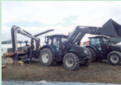
ホイールローダーにグラップルとチップパーを付属させた高性能林業機械
