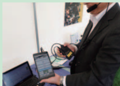
山土場での材積集計（検知）システム 音声で樹種・胸高直径・樹高を入力することができる。写真解析による集計システムも開発中。精度はまだ90%程度で実用段階ではない。
