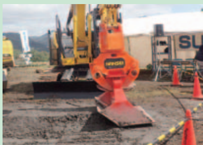
大義バケット 森林作業道の法面成型に使用する脱着可能なバケットで自在成型が可能。 より強度のある作業道が作設できる。
