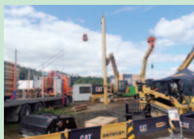
クイックタワー タワーをアタッチメントとして取り付けたタワーヤーダとスイングヤーダを合わせたような機械
