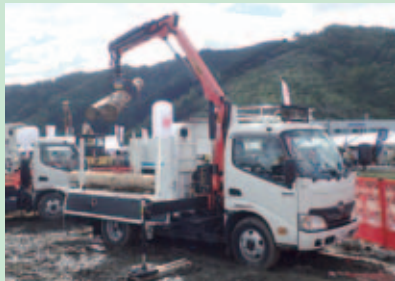
グラップル付トラック「グラトラ」 グラップルとトラックの能力があり一人での搬出作業が可能
