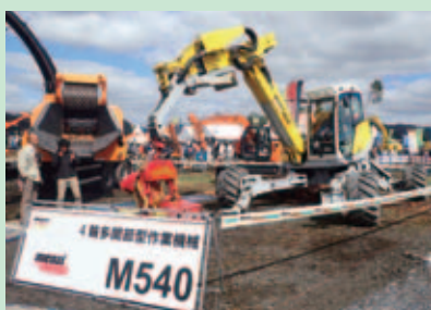
4輪ホイールタイプのプロセッサ 幹材や丸太等の障害物を乗り越えられる構造を持つ4輪多関節型のプロセッサ
