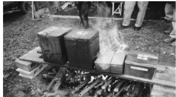
釜及び炭化作業状況
