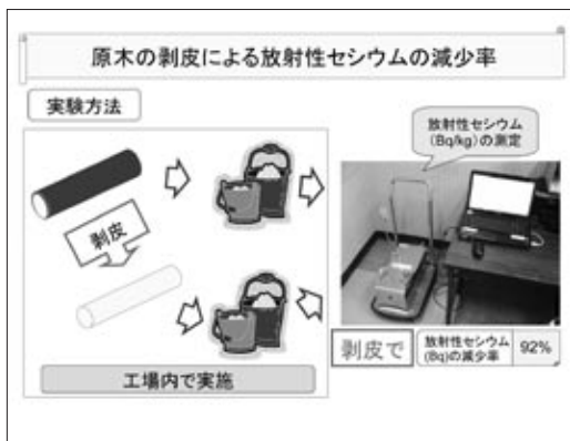
図4 原木の剥皮による放射性セシウム減少率
