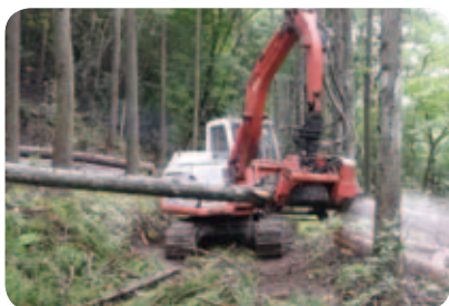
プロセッサによる造材作業実習
