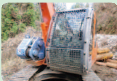
防護柵を装備した林業機械
