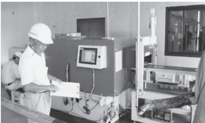
原木の非破壊検査機器
