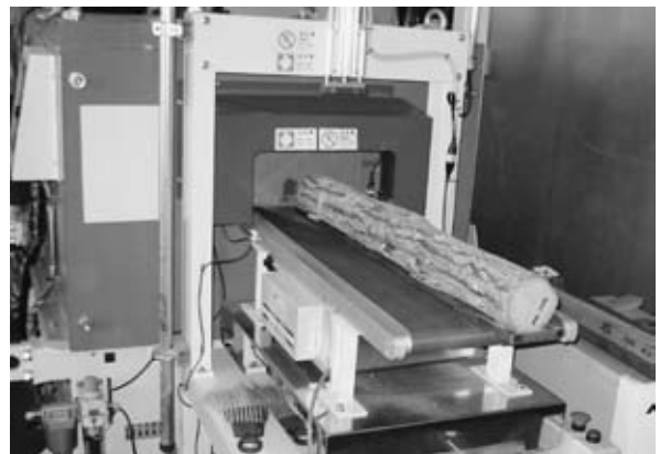
非破壊型放射性物質検査機器
