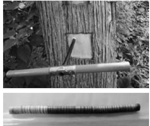
図2 成長錐を用いた標準調査木からの材の採取状況（上）と、採取した材サンプル（下）
