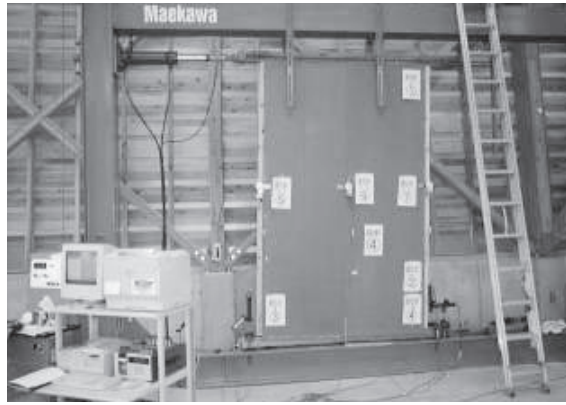
耐力壁面内せん断試験実施状況
