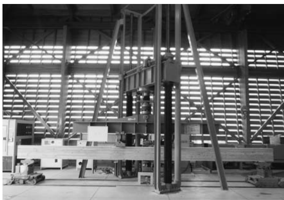
実大曲げ強度試験実施状況
