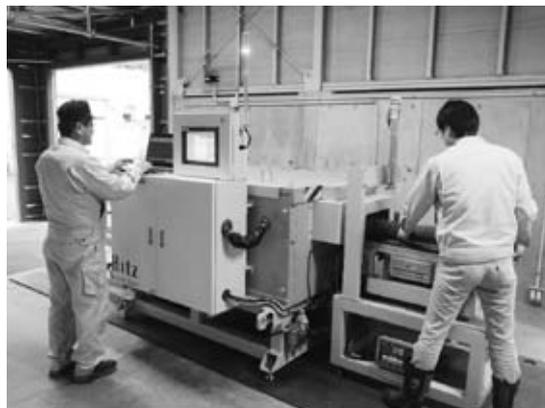
しいたけ原木非破壊検査機器
