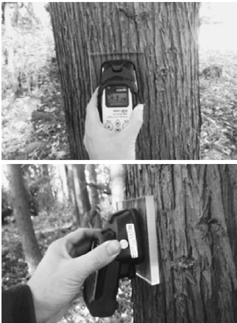
図-3 スギ樹皮放射性セシウム濃度の簡易推定技術の開発 サーベイメーターによる樹皮の放射性物質測定状況
