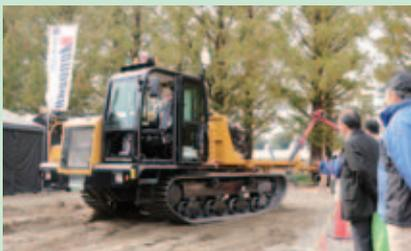
遠隔操作装置を取付けたフォワーダ標準機に簡易装着が可能、リモコン操作で操縦範囲は1km、有人から遠隔操作への切替は1分で終了
