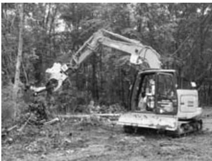
ウルトラザウルス（フェラパンチャ・ウィンチ付きバックホウ）による土場の作設状況
