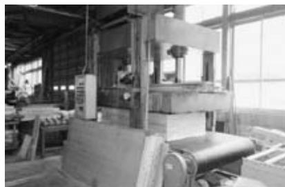
幅はぎ板の積層接着 (プレス機による圧締)
