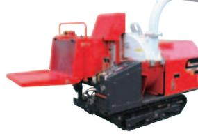
破砕径：200mm 出力：18.4kW
