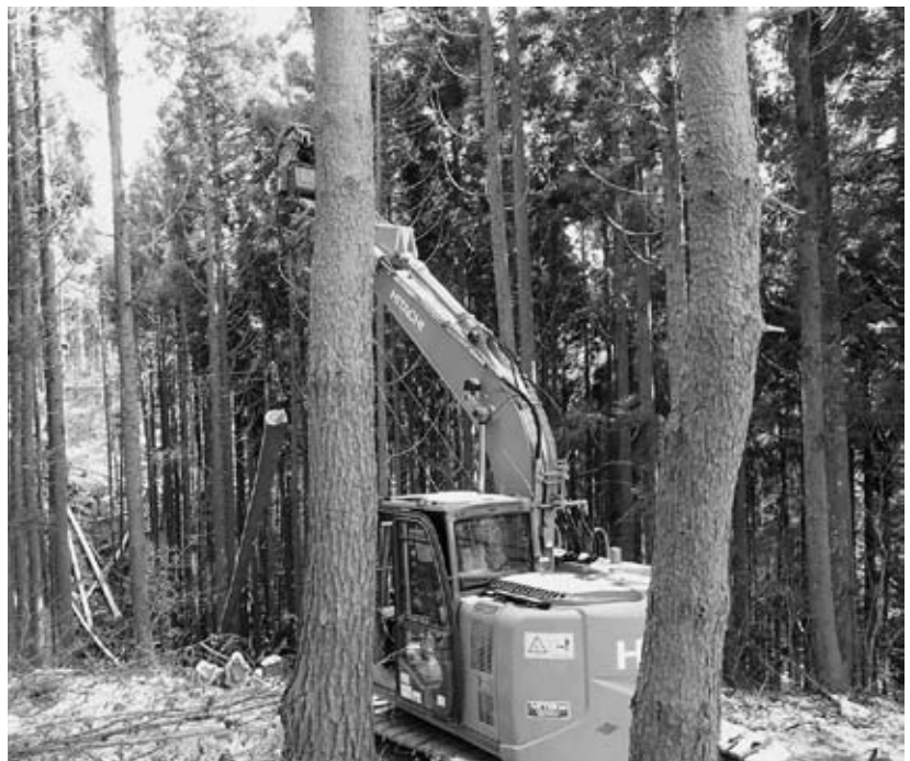
写真：スイングヤーダによる架線集材
