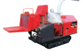
破砕径：200mm 出力：18.4kW
