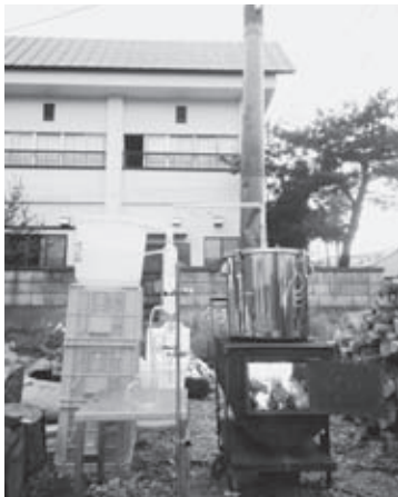
黄河社製の精油抽出機とMOKI製作所の防災ストープを組み合わせた、熱源自給型の蒸留システム
