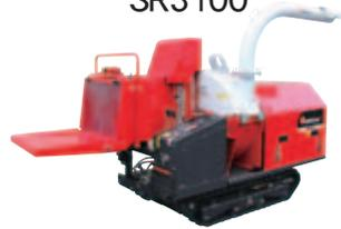
破砕径：200mm 出力：18.4kW
