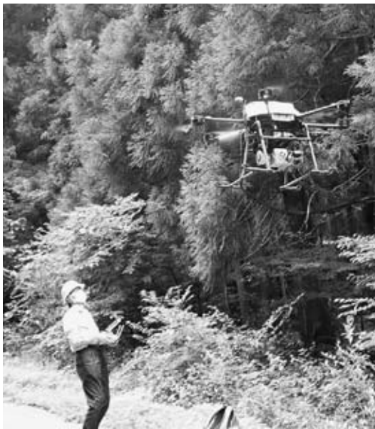
写真3 線量計等を積載したドローン（大和田測量設計(株)、日本大学工学部との共同研究）
