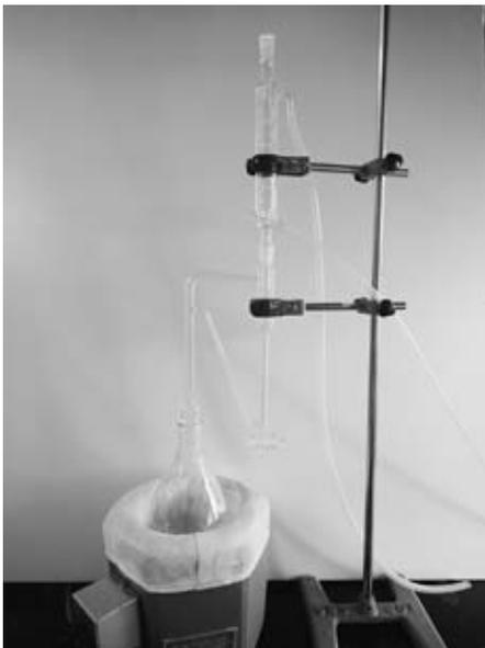
図一四 使用した精油定量器
