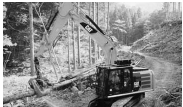
ハーベスタ（伐倒～枝払い～玉切りの工程が1台で行えます） ※日本キャタピラー合同会社HPより
