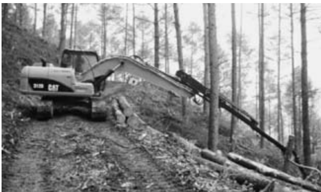
ロングリーチグラップル（広範囲の伐倒木を集材できます） ※林野庁HPより
