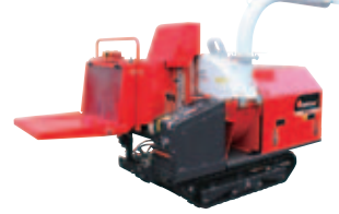
破砕径：200mm 出力：18.4kW
