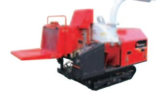
破砕径：200mm 出力：18.4kW
