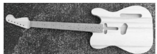
写真-2 コナラフリー板で試作したギターの本体(ヘッド・ネック部分はヒノキ製で、フィンガーボードはケヤキ製)
