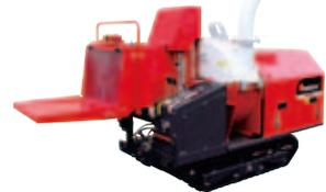
破砕径：200mm 出力：18.4kW
