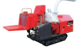
破砕径：200mm 出力：18.4kW
