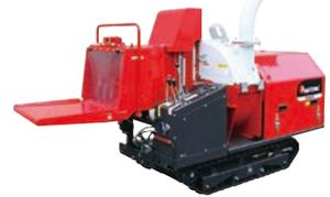
破碎径：200mm 出力：18.4kW
