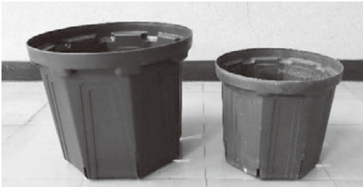
図－4 試験に利用したポット 左：外径40cm、右：外径30cm
