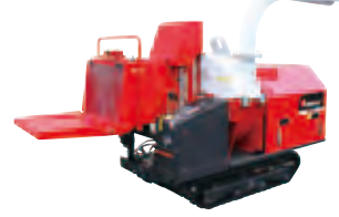
破砕径：200mm 出力：18.4kW
