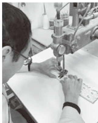
電動糸鋸で小物のパーツを製作する様子
